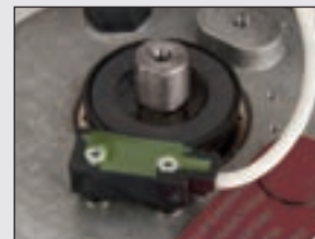
Encoder magnetico per garantire la massima sicurezza. Magnetic encoder guarantees the maximum safety.
