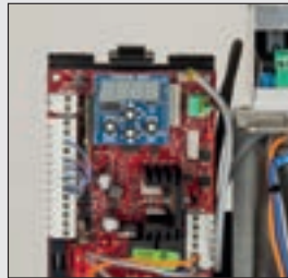
Scheda elettronica con display nella versione da 1.000Kg 24V
